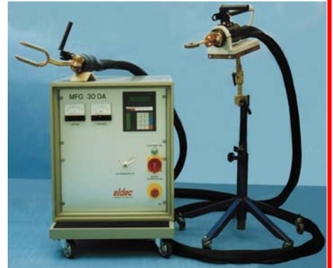
30-kW-Mittelfrequenzgenerator Typ eldec MFG 30 DA in mobiler Bauform. Mit den beiden Kabelausgängen kann im Wechseltakt erwärmt, z. B. gelötet, werden. Es ist auch möglich, daß ein Ausgang zum Löten und der andere Ausgang über eine Kabelbox zum Fügen oder Lösen von Schrumpfverbindungen eingerichtet wird.
