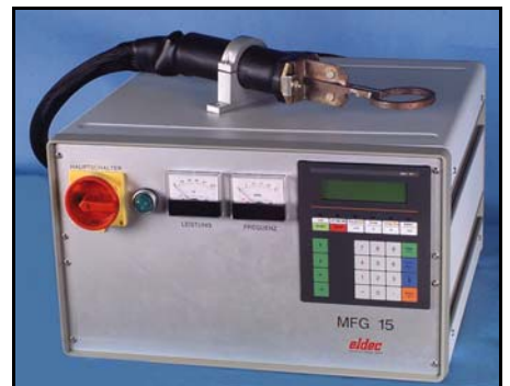
15-kW-Mittelfrequenzgenerator Typ eldec MFG 15 als Tischgerät. Auf dem Generator liegt der Koaxialhandtransformator mit angeklemmtem Induktor, der sowohl von Hand als auch maschinell geführt werden kann. Auf der Frontseite ist der Hauptschalter, je ein Anzeigeinstrument zum Ablesen der Ausgangsfrequenz und der Ausgangsleistung in Prozent der Nennleistung sowie ein Bediengerät angebracht.
