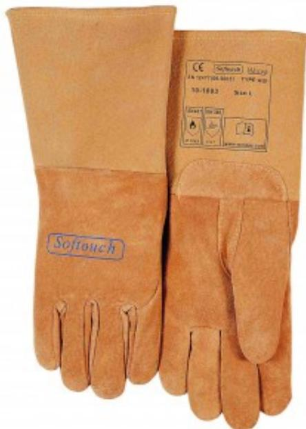
Weldas® WIG Handschuhe (10-1003, 10-1005, 10-1009, 10-1050), haben einen 'nahtlosen' Zeigefinger. Dies gibt ungehinderte Kontrolle über Schweißelektroden mit einem kleinen Durchmesser und ultra-leichtem WIG-Brenner. Diese Ausführung verhindert das Ausbrennen der Nähte sowie Abrieb.
